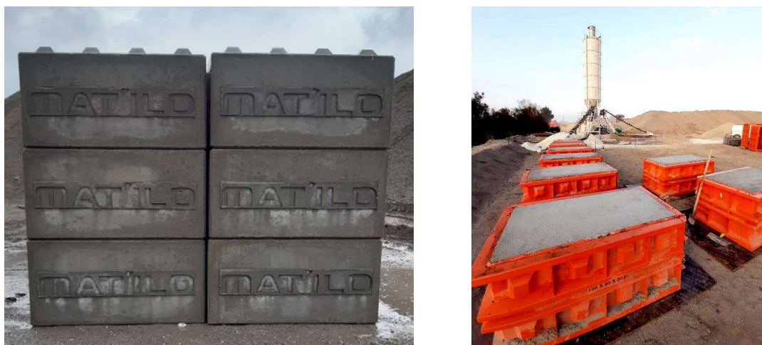
FIGURE 11 : EXEMPLE DE MOULAGE DE BIG BLOCS
